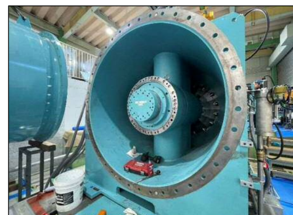
水車内部のスラスト軸受とガイドベーン(上流から撮影) (水車軸の奥に見えるガイドベーン：水量調整羽根)
